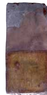
3b Großformatiger Rechteckschnitt vom Langhausdach des Konstanzer Münsters, um 1239. Die untere Hälfte ist mit einer transparenten, bleihaltigen Glasur versehen.
