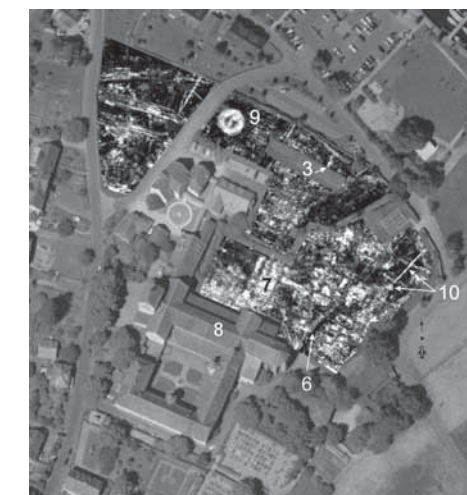
5 Reichenau, Klosteranlage Mittelzell. Ergebnis der Bodenradar-Untersuchung in einer Tiefe von ca. 0,80 m
