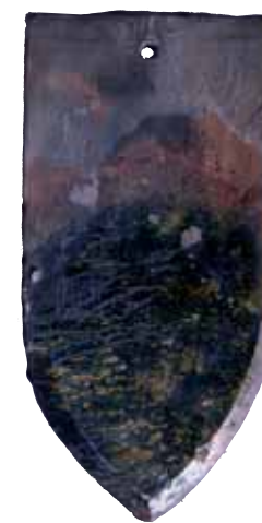
5b Ravensburg, Grüner Turm. Ziegeltyp 23 (in der Kartierung olivgrün) der Dachdeckung des 15. Jahrhunderts.
