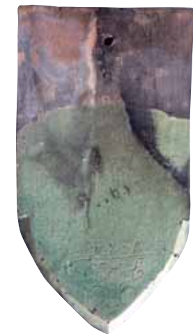
5c Ravensburg, Grüner Turm. Ziegeltyp 20 (in der Kartierung moosgrün), der bei einer Wiederherstellung 1824 verlegt wurde.
