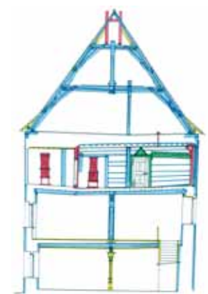
7 Veringenstadt, Rathaus. Baualtersplan Querschnitt. Über den im Inneren nur durch die Stützenstellung gegliederten beiden unteren Geschossen befindet sich das in Fachwerk errichtete zweite Obergeschoss mit den beiden Bohlenstuben. Darüber das mittelalterliche Dachwerk, in dem durch eine Hängesäule die Deckenlast über der großen Bohlenstube abgefangen wird.
