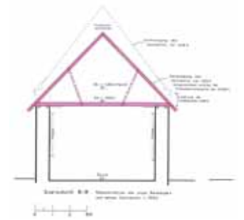
12 Auf Grund der Bearbeitungsspuren, seiner Abbundzeichen, der Holzlängen, einer Putzabdruckante eines früheren Dachwerks an der Giebelwand des Kirchenschiffes und einer nachgewiesenen Erhöhung des Chor-Raums lassen sich die sekundär verwendeten Dachbalken und Sparren einem früheren Dachwerk von 1303 zuordnen, das sich ursprünglich über dem Chor der St. Afra Kapelle befand.
