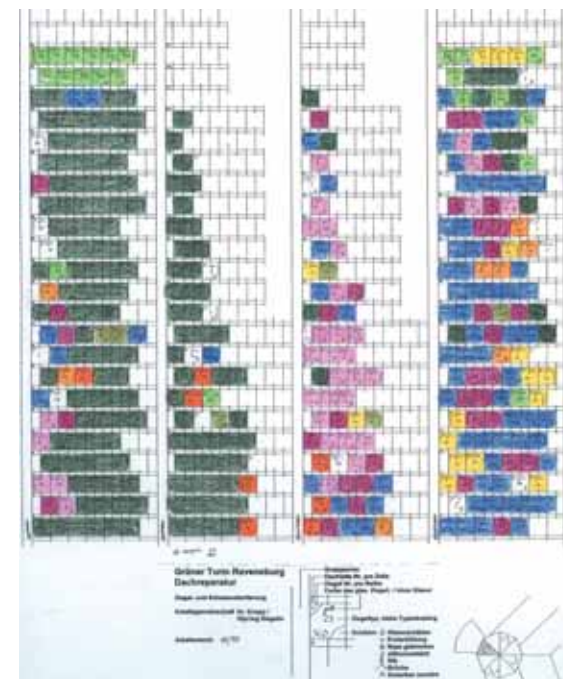
5a Ravensburg, Grüner Turm. Ausschnitt aus der Ziegelkartierung. Die Ziffern bezeichnen den Ziegeltyp, die Farbangaben die Glasurfärbung und die Symbole Art und Grad eventueller Schäden.
