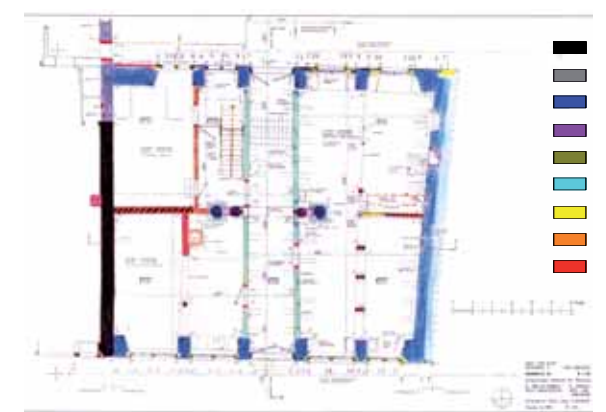
4 Grundriss Baualtersplan mit Darstellung der verschiedenen Bauphasen
