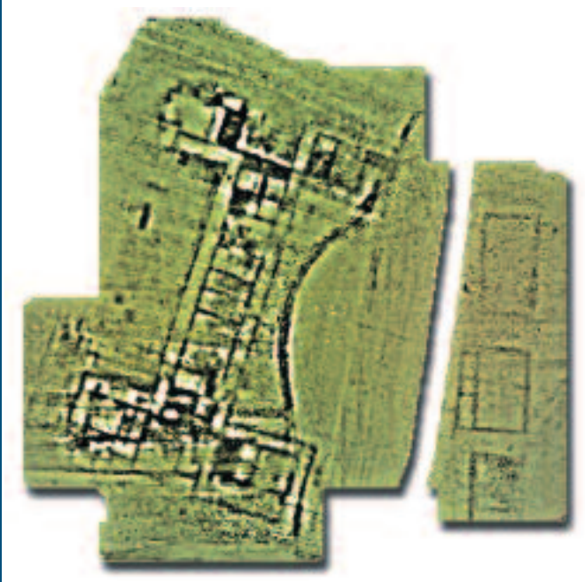
Stettfeld bei Ubstadt-Weiher (Lkr. Karlsruhe). Durch die flächige geoelektrische Prospektion wurde der Grundriss einer römischen Palastvilla erfasst, deren Reste heute unsichtbar unter Streuobstwiesen verborgen sind.
