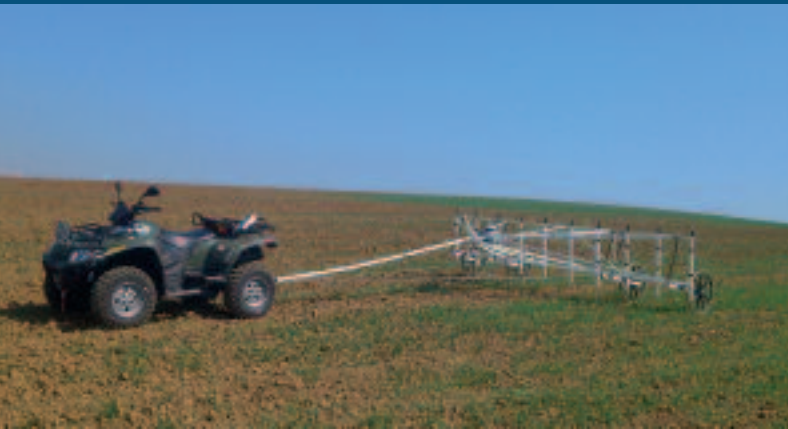
Mit einer zehnkanaligen Messapparatur können pro Tag sehr große Flächen geomagnetisch kartiert werden.
