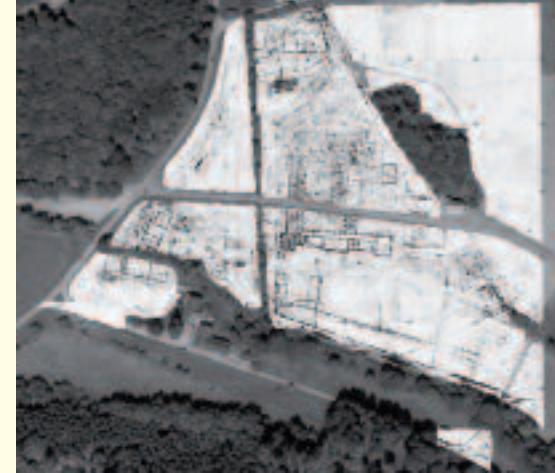
Kloster Tennenbach bei Emmendingen. Hier konnten mit 25 freiwilligen ortsansässigen Helfern über 4278 Radarprofile mit einer Gesamtlänge von 140,37 km abgefahren werden. Das Verfahren ermöglichte die Erfassung des Grundrissplans des abgegangenen Klosters.
