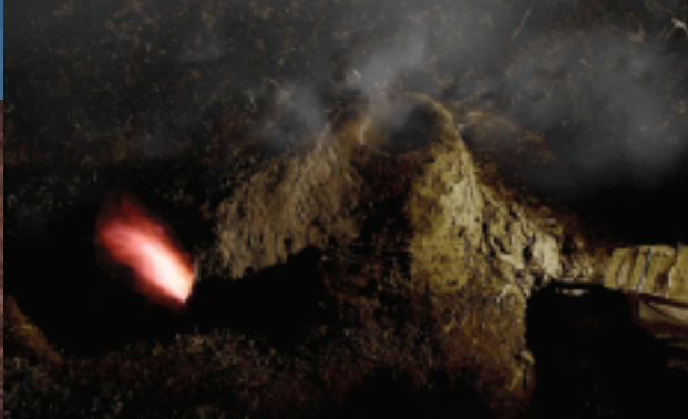
Ofenbetrieb bei Nacht: Aus der Ofenschnauze schlägt die „Gichtflamme“
