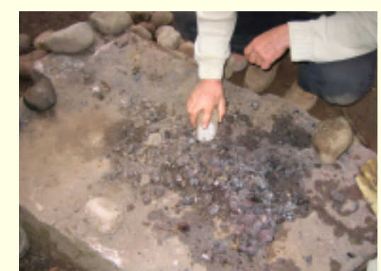
Zerkleinern des Erzes mit einem Pochstein
