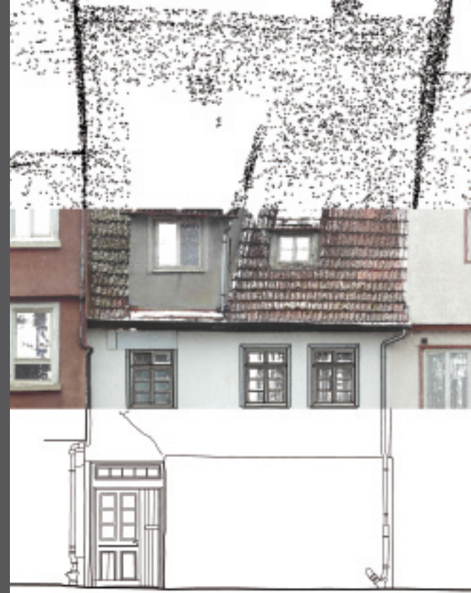
Auswertung von Laserscandaten: Punktwolke, Orthofoto, Umzeichnung
