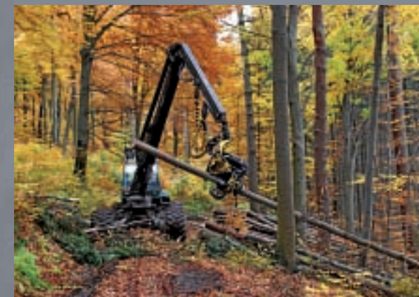
Ein Harvester mit Kran im Einsatz – auch hier können die Bäume z.B. über Wälle und Terrassenkanten gehoben werden. Ein Reisigbett kann in sensiblen Bereichen den Boden schützen.
