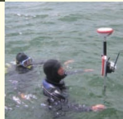
Kontrolle von Erosionsvorgängen. Forschungstaucher messen mit dem Präzisions-GPS.
