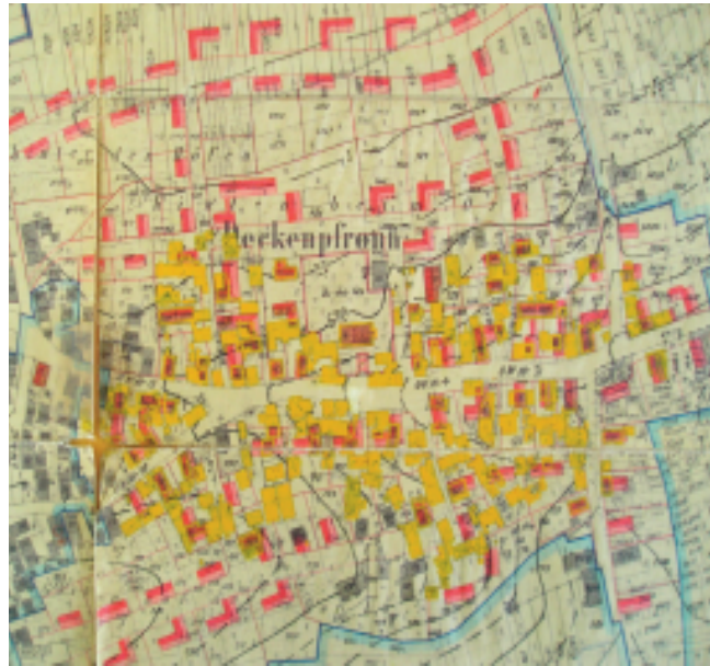
Plan der Baulandumlegung vom 08.02.1946, angefertigt durch Regierungsvermessungsrat Charrier: Gelb die Zerstörungen von 1945, rot die neu geplanten Gebäude, grau die erhaltenen geblieden Gebäude
