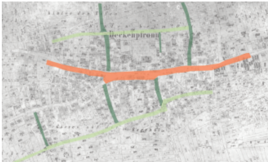
Die neue Straßenplanung für Deckenfronn: Die einst schmale Hauptstraße (rot) wurde marktartig aufgeweitet und begradigt; Nord und Südstraße (hellgrün) gehen quer durch bisher unbebautes Gartenland und werden mit Stichen (dunkelgrün) an die Hauptstraße angebunden.
