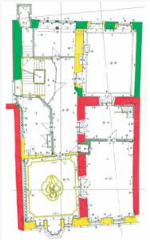
Am Grundriss des 1. Obergeschosses ist die Bauentwicklung des einstigen Patrizierhauses dargestellt: rot für den mittelalterlichen Kernbestand, grün für die frühneuzeitliche Erweiterung zum Hof hin und gelb für die historisierende Straßenfassade.
