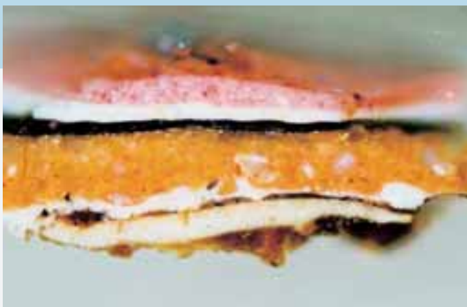
Diese Querschliffaufnahme zeigt in 120-facher Vergrößerung eine Schichtenfolge von Bleiweiß mit Bindemittelschicht, Mennige, Blattsilberauflage, rotem Lüster sowie Bleiweiß-Ausmischung aus rotem Ocker und Bleiweiß.
