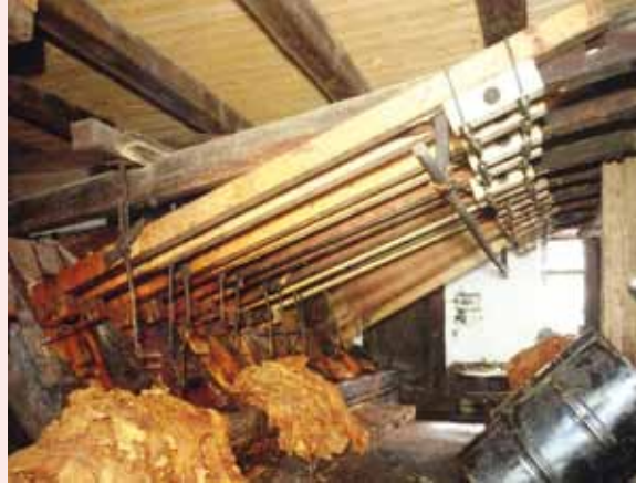
Hierfür reiben von Wasserkraft angetriebene Hämmer Weißkalk und Dorschtran in die Häute, die anschließend im Dach und Obergeschoss oder, bei schönem Wetter, im Freien zum Trocknen aufgehängt werden.
