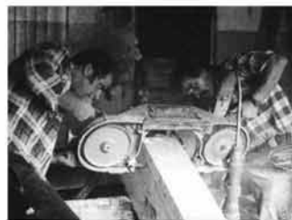
Abb. 197 Einsatz einer tragbaren Bandsäge bei der Herstellung eines geschweiften Buges.
