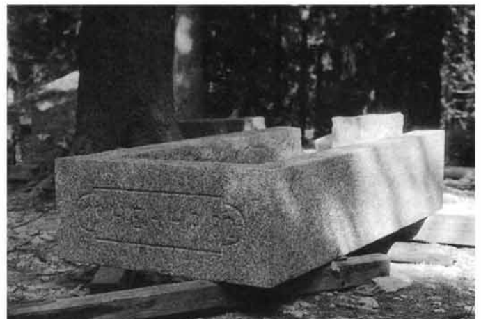
Abb. 178–180 Herstellung des Ofensteins für den Kachelofen des Oberen Geschwendhofes. Die Ofensteine müssen aus Findlingsgranit gehauen werden, Steinbruchgranit hält die Temperaturspannungen nicht aus und reißt. Der Steinmetz hat seinen Arbeitsplatz bei einem geeigneten Findling im Wald eingerichtet.
