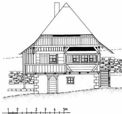
Abb. 312–314 Querschnitt und Ansichten des Waldarbeiterhauses in Schiltach-Lehengericht. Sanierungsplanung.
