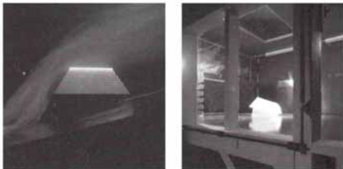
Abb. 152 und 153 Modell eines Höhenhauses im Windkanal der Firma Porsche.
