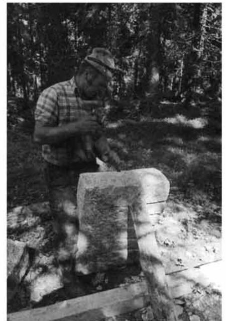
Abb. 178–180 Herstellung des Ofensteins für den Kachelofen des Oberen Geschwendhofes. Die Ofensteine müssen aus Findlingsgranit gehauen werden, Steinbruchgranit hält die Temperaturspannungen nicht aus und reißt. Der Steinmetz hat seinen Arbeitsplatz bei einem geeigneten Findling im Wald eingerichtet.
