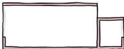
Zweiseitige Belichtung mittels Fensterband: bedingt durch das Flachdach auf einer Seite sehr hohe Fenster
