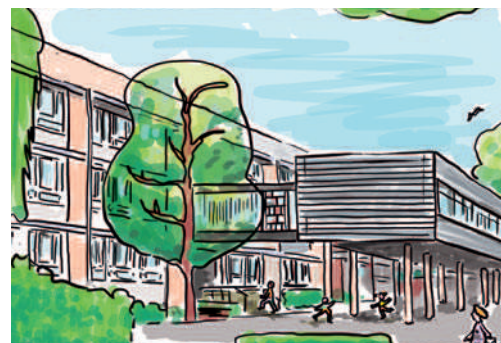
Ein Beispiel für den "Schustertyp": Ein dreigeschossiger Riegel mit zwei Treppenhäusern, welche die Klassenzimmer erschließen und ein parallel stehender Riegel mit Fach- und Verwaltungsräumen sowie Übergängen ins 1. OG der Treppenhäuser.
