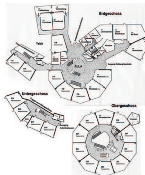
Die Schäfersfeldschule (1972-74) in Lorch: Der zehneckige Baukörper wird mittels fünfeckiger Klassengrundrisse ausgebildet und mündet in einer fünfeckigen Glaskuppel.
