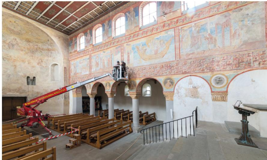
der maximal möglichen Entfernung aufzunehmen. Somit konnten perspektive Fehler bei der Bildentzerrung minimiert werden. Diese Konfiguration war erforderlich, da die Oberfläche der Wand zum Teil erhebliche, unter anderem tagwerksbedingte Tiefenunterschiede aufweist. Die gleichmäßige und schattenfreie Ausleuchtung der Flächen wurde mit einer leistungsstarken, professionellen Blitzanlage realisiert.
