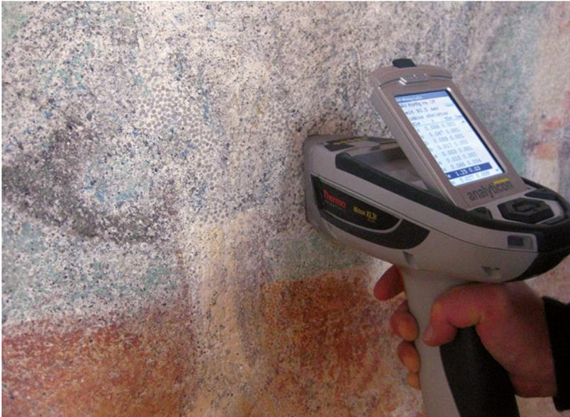
sung des Detektors liegt für Mn-Ka bei ca. 150 eV. Mit der im Analysator eingebauten CCD-Kamera kann die analysierte Probenoberfläche während der Messung dokumentiert werden.
