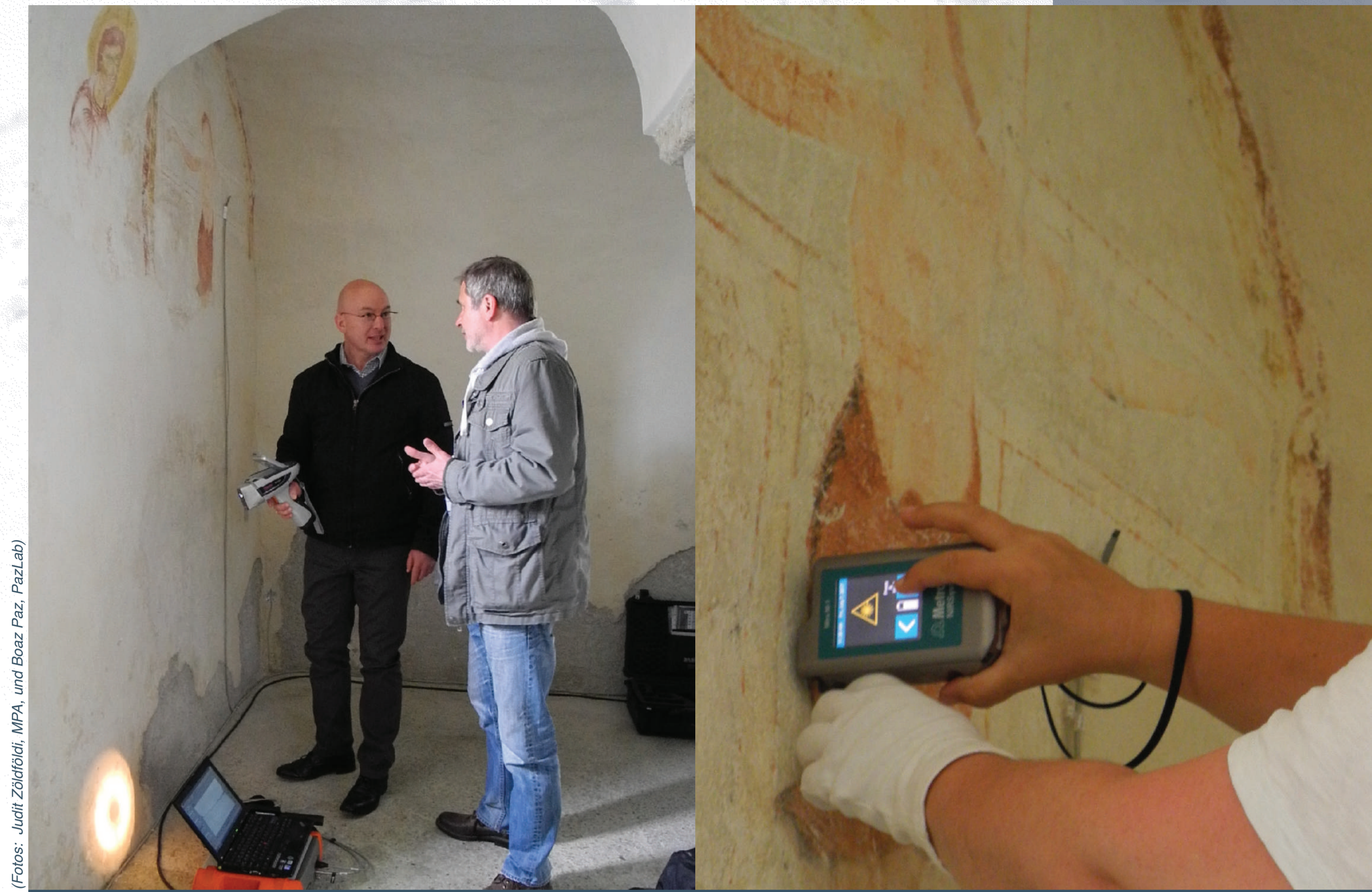
Zum Einsatz kamen (1) Röntgenfluoreszenz-, (2) Nah-Infrarot- und (3) Raman-Messgeräte; die Messungen konnten vor Ort, zerstörungsfrei und relativ schnell (wenige Sekunden bis zu 2 Minuten) durchgeführt werden
