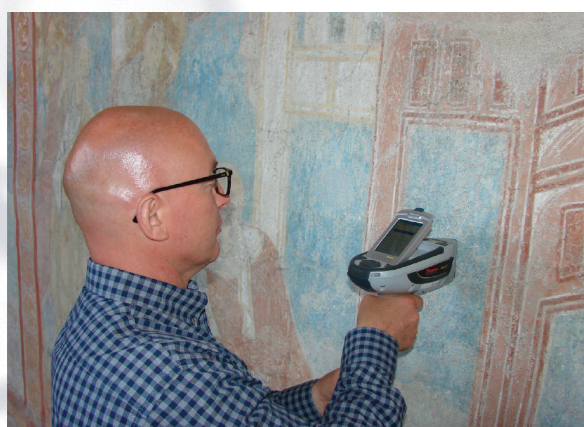
Chemiker Dr. Boaz Paz bei der Untersuchung der Pigmentzusammensetzung mittels eines portablen Röntgenfluoreszenzgerätes Chemist Dr. Boaz Paz investigating the pigment compound using a portable X-ray fluorescence device
