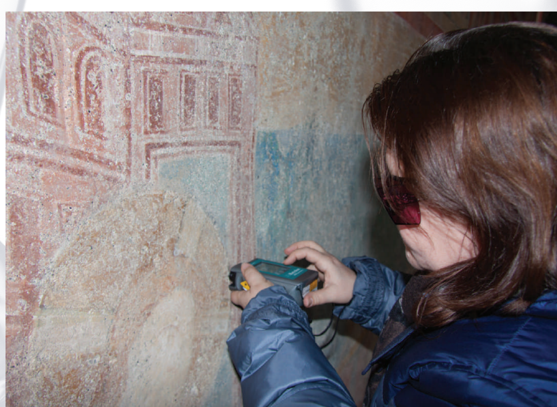
Geologin Dr. Judit Zöldföldi bei der Untersuchung der Pigmentzusammensetzung mittels eines transportablen Raman-Spektrometers Geologist Dr. Judit Zöldföldi examining the pigment compound using a transportable Raman spectrometer
